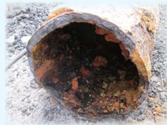
長年使用した水道管の内面
